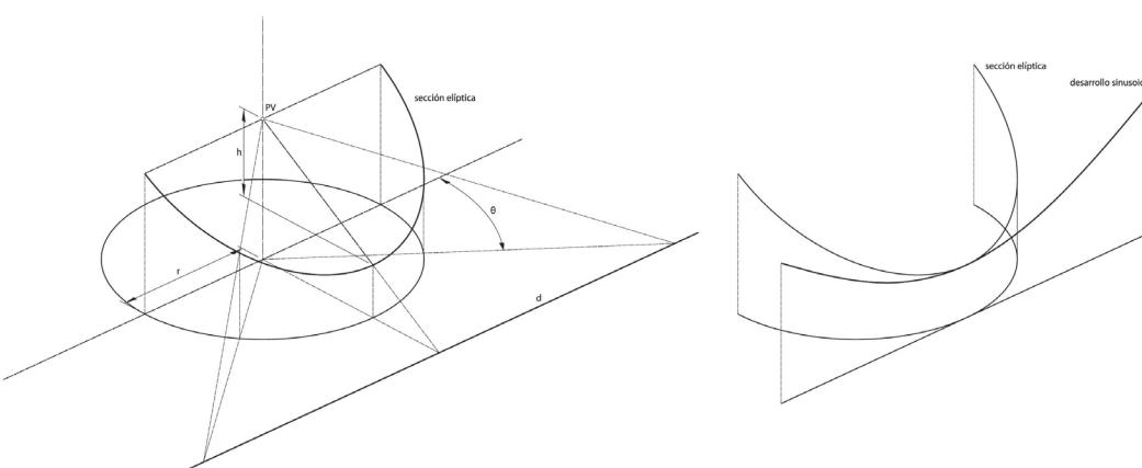
4. División equidistante de una dirección, sobre la pantalla cilíndrica. PV: punto de vista; fa,fa': puntos de fuga de la dirección proyectada.
