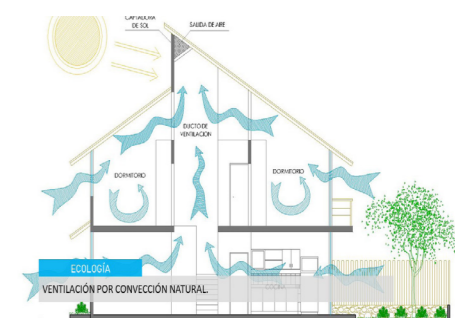
Imagen 12 Sistema de ventilación natural por convección.
