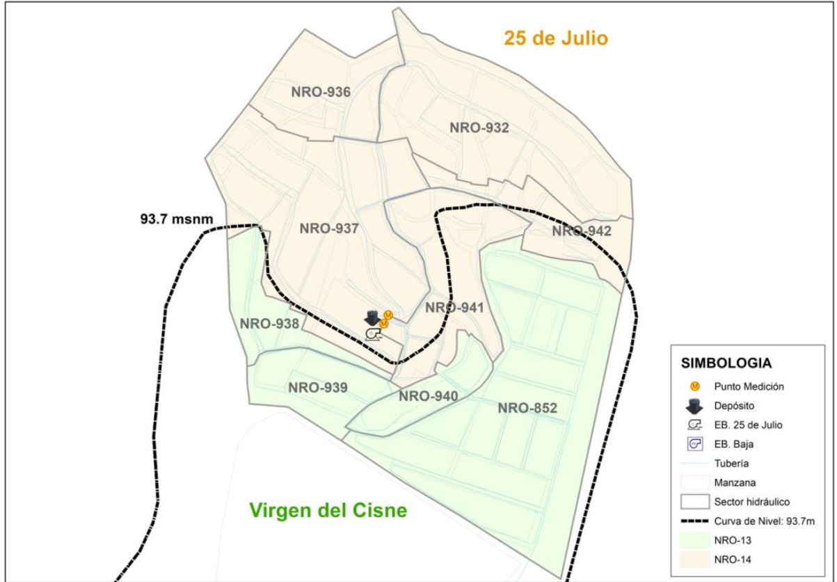
Figura 6.1: Cota máxima para abastecimiento desde reservorio
