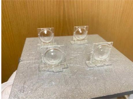
Figura 4. Imagen de los modelos de SEC obtenidos con la impresora 3D
