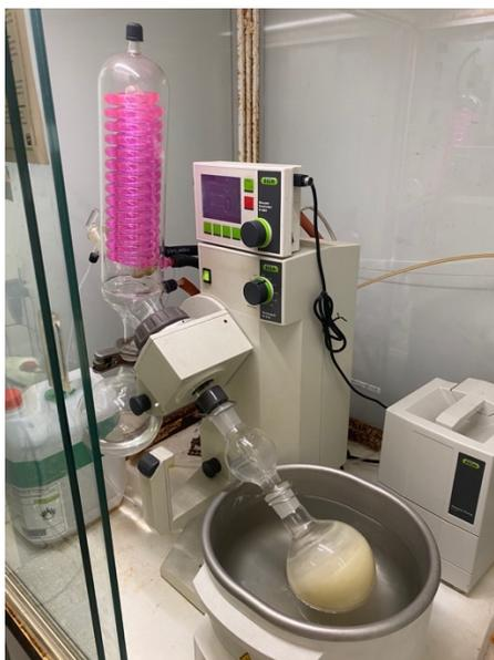
*Figura 14. Montaje con rotavapor y entrada de Nitrógeno*
