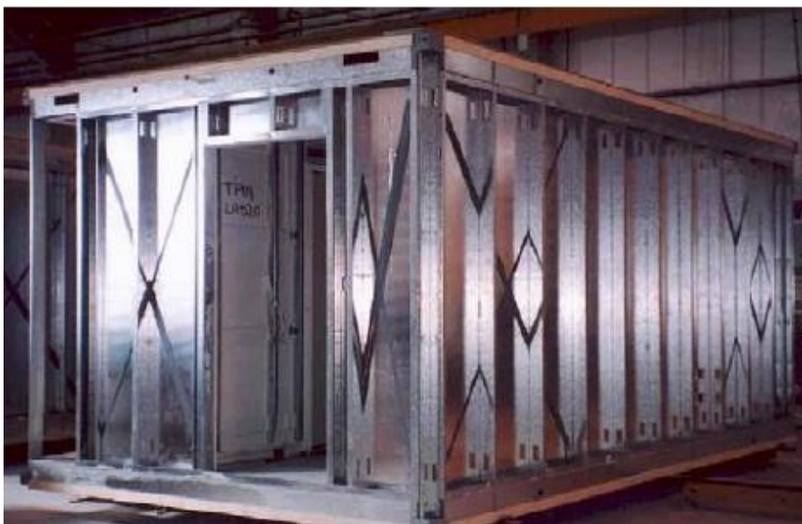
Figura 2.1: Sistema con muro portante (4)
