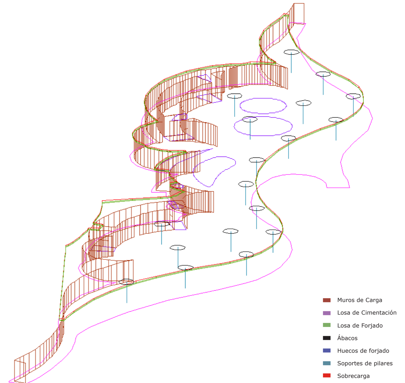
Imagen: Modelo de cálculo estructural de Cocotea, elaboración propia
