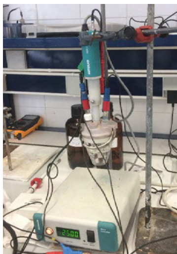
Fig. 3 Montaje experimental de la Práctica 1: Electrodo de disco rotatorio
