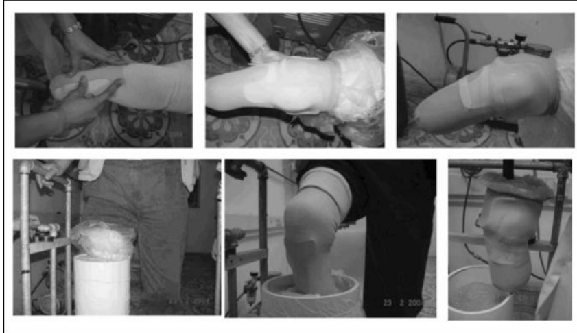
Figura 7. Fabricación de sockets con moldes de arena.
