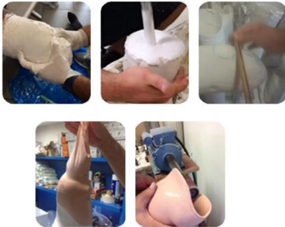
Figura 3. Proceso de fabricación de sockets con yeso.
