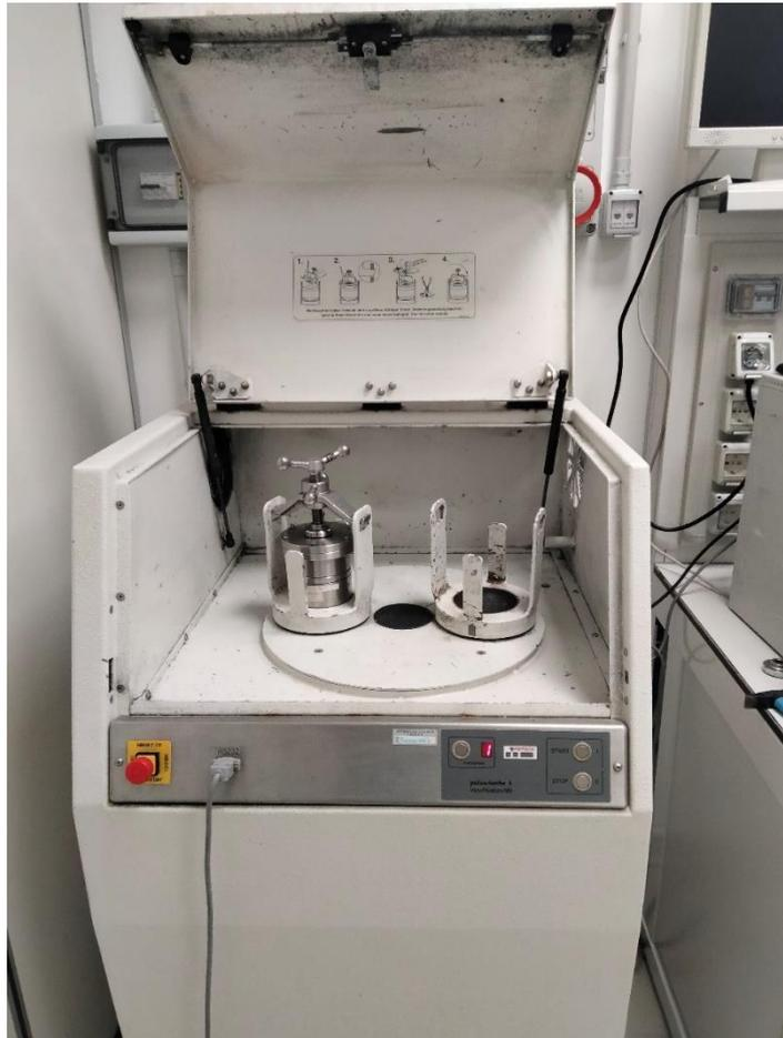
**Imagen 13.** Molino planetario disponible en el laboratorio.
