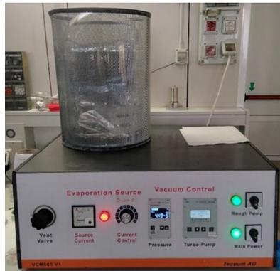
**Imagen 23.** Evaporador Tecuum AG VCM600 V1.
