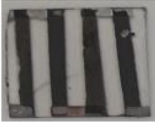
**Imagen 28.** TEG no optimizado y sulfurizado tras TT2
