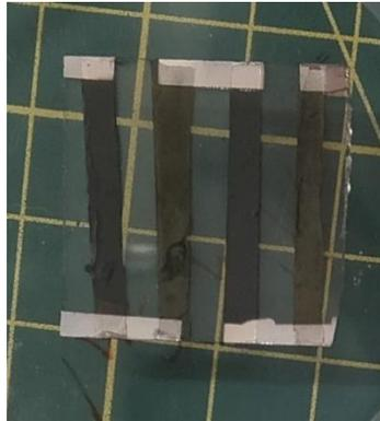
**Imagen 25.** Termogenerador no optimizado.
