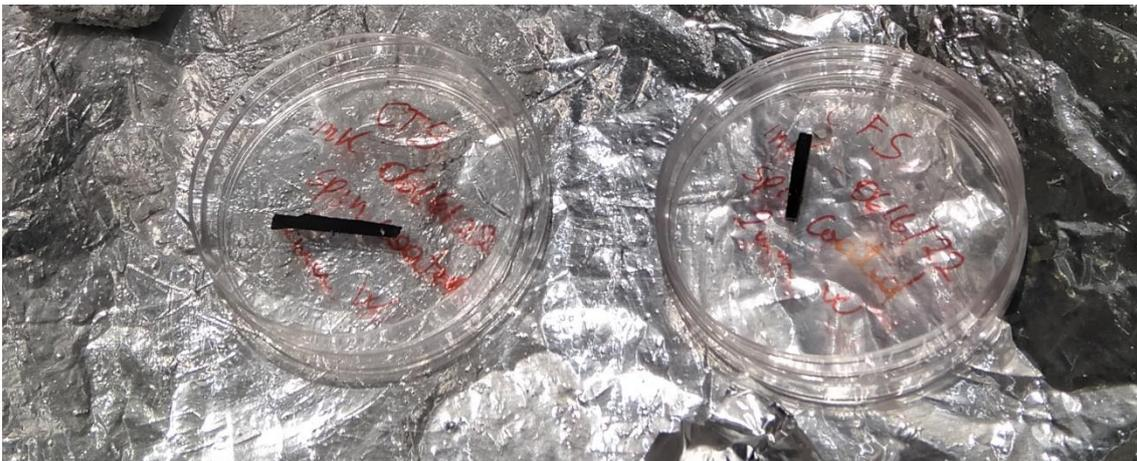
**Imagen 14.** Muestras de CFS sulfurizado y no sulfurizado para medir la resistividad.
