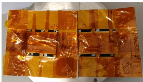
**Imagen 24.** Máscara usada para la deposición de plata.
