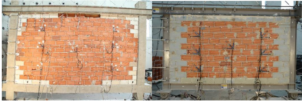
Figura 2-3: Ejemplos de esquemas de aislamiento con elementos SISBRICK.
