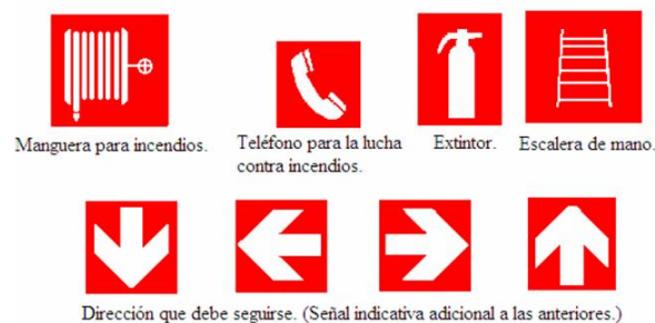
Figura 22. Señalización en caso de incendio
