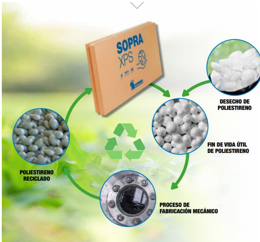
Ilustración 58. Proceso de reciclaje paneles de XPS
