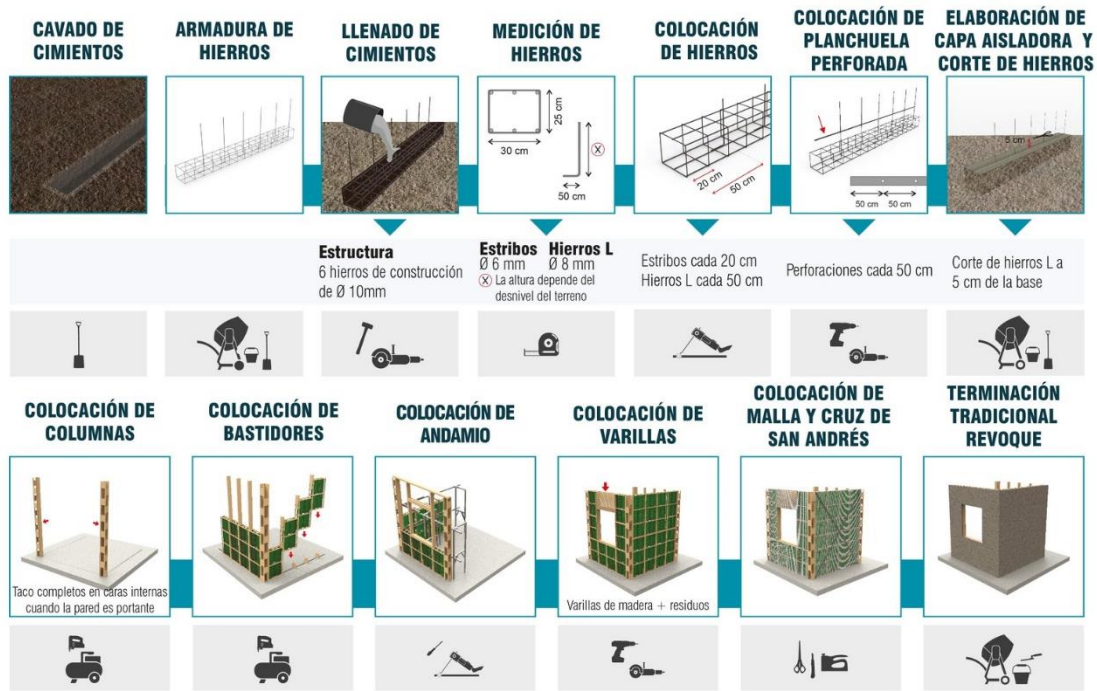
Ilustración 28. Proceso constructivo sistema 3C Construcciones
