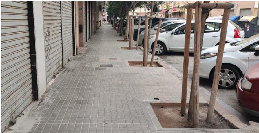
Fig. 78. Imagen de la acera donde se observa el buffer creado por los alcorques.
