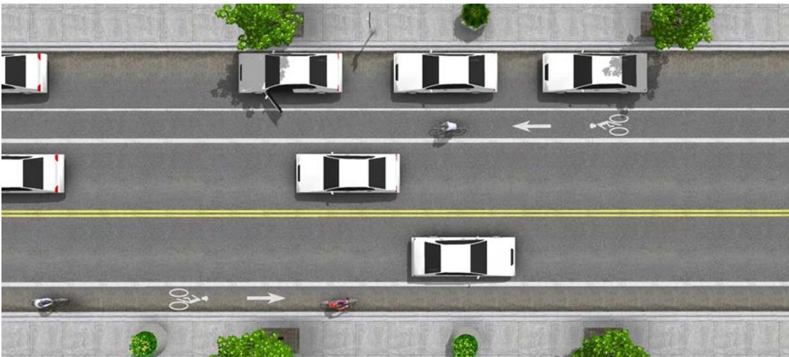
Fig. 33. Disposición de marcas viales característica de EEUU. Fuente: National Association of City Transportation Officials. Urban Bikeway Design Guide. 2011.
