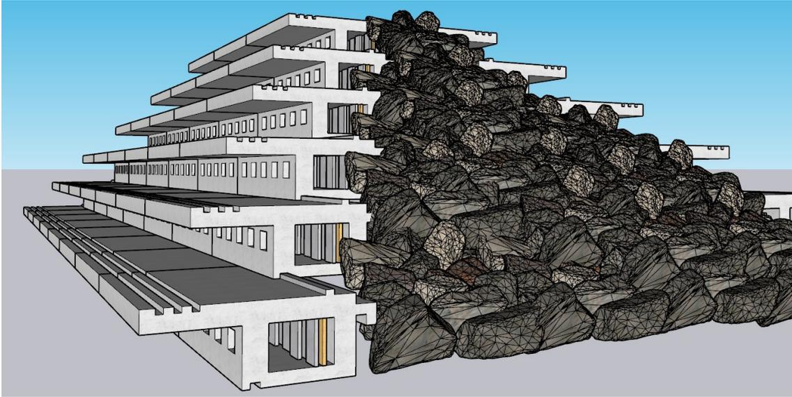
**Ilustración 20. Distribución de las rocas en núcleo de nuestra infraestructura arrecifal con un gran conjunto de módulos.**
