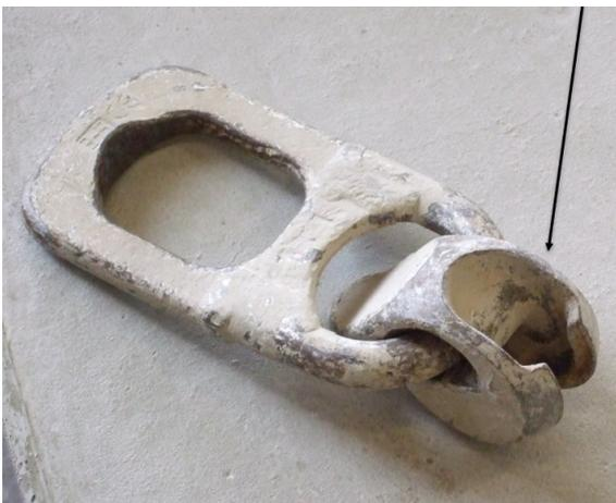
**Ilustración 41.** Dispositivo de anclaje para el bulón.
