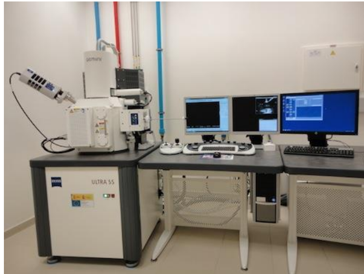
Figura 74. Microscopio electrónico de barrido de emisión de campo (FESEM) empleado en la caracterización morfológica de los materiales degradados. Fuente: Servicio de Microscopía de la UPV
