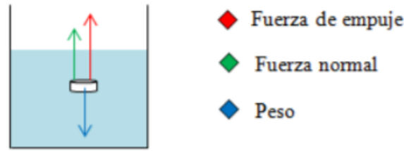
Figura 53. Esquema de las fuerzas que aparecen al sumergir un cuerpo en un fluido.
