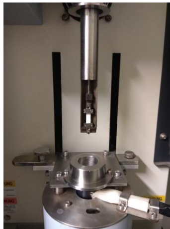
Figura 36. Posición de la probeta en el dilatómetro para medir el módulo elástico a tracción.
