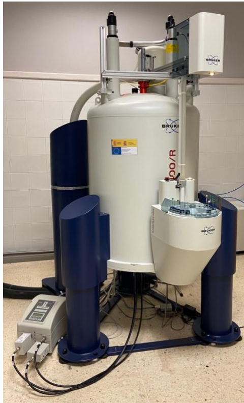
Figura 3.2. Equipo empleado para realizar los análisis de RMN. En concreto se trata de un espectrómetro Bruker Ascend 400/R (Bruker Española S.A).
