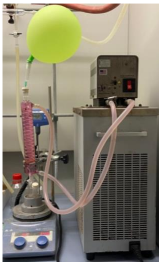
Figura 3.11. Reacción a reflujo bajo atmósfera de argón. Previamente al inicio de la reacción se purgó el sistema para así eliminar el oxígeno atmosférico.
