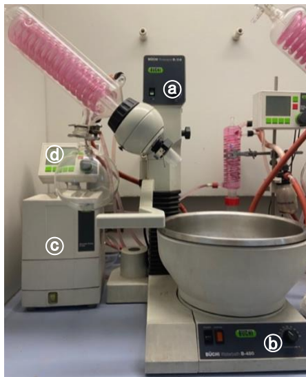
Figura 3.1. Rotavapor empleado para la evaporación de los disolventes. ① Büchi Rotavapor R-114 (BUCHI Ibérica S.L.U.). ② Baño de agua (Büchi Waterbath B-480, BUCHI Ibérica S.L.U.). ③ Bomba de vacío (Büchi Vacuum Pump V-700, BUCHI Ibérica S.L.U.). ④ Controlador de vacío (Büchi Vacuum Controller V-850, BUCHI Ibérica S.L.U.).
