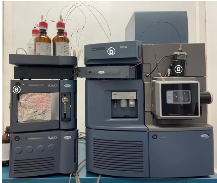
Figura 3.6. Equipo de UPLC-masas. ① Sistema ACQUITY UPLC (Waters Corp.). ② Espectrofotómetro Waters ACQUITY™ Xevo QToF (Waters Corp.). ③ Interfase de ionización por electrospray (ESI).
