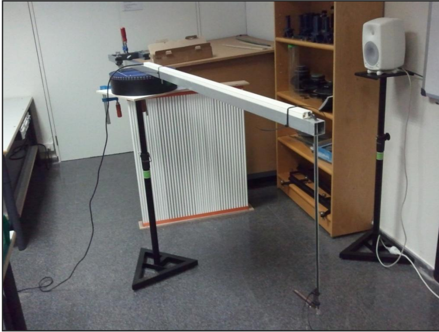
Fig. 20.- Montaje del brazo robotizado que sujeta el micrófono
