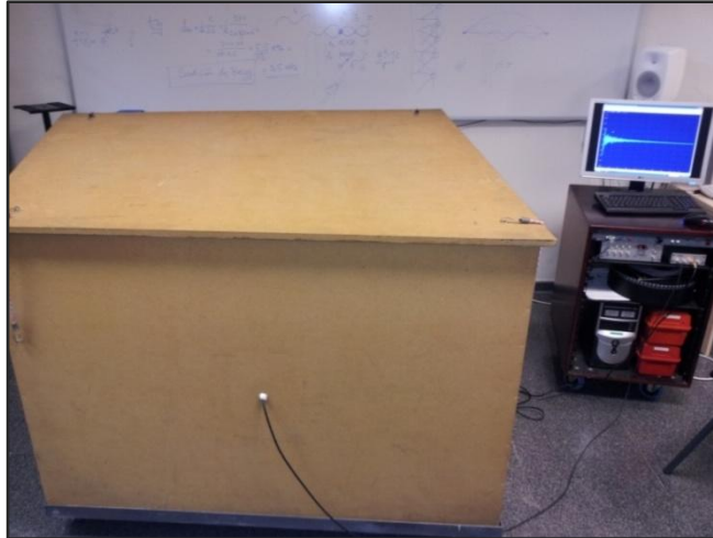
Fig. 33.- Método de medición en sala real a escala
