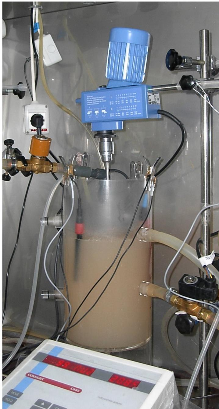
Figura 8.2. SBR utilizado durante el periodo experimental.
