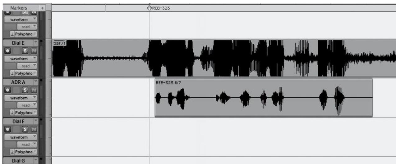
**Figura 3.1.5.** Cuando se sincronice una línea de ADR manualmente, hay que mover la pista de ADR o la pista ADR de trabajo -según la que se esté usando-, justo debajo de la pista de diálogo de referencia. Prestar atención a que la pista ADR está temporalmente posicionada entre Dial E y F.
