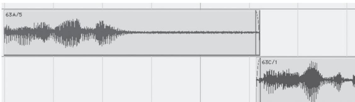
**Figura 2.8.14.** Si la región sobre la que se está aplicando la transición no dispone de margen apropiado, o si las transiciones resultan en cambios audibles de tono de sala, se puede esconder la transición en el ataque de la siguiente pista.
