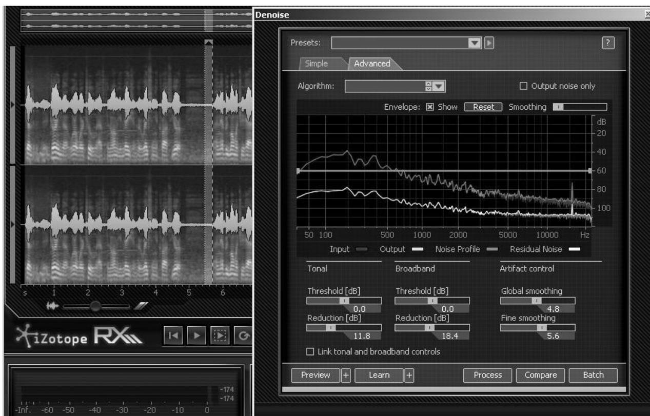
Figura 2.9.3. De-noiser Izotope®RX configurado para eliminar un patrón de ruido de fondo seleccionado en la forma de onda original.
