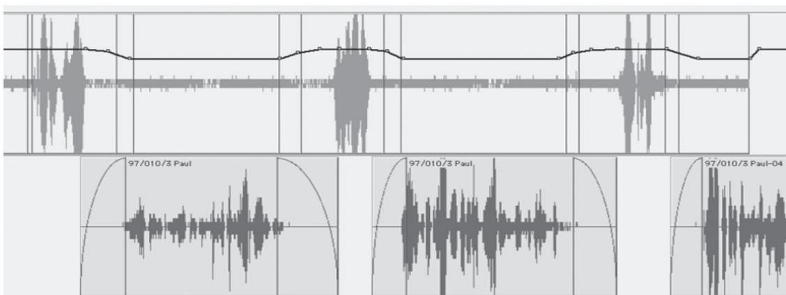
**Figura 2.8.18.** Aunque la pista del radio-micrófono de la pista inferior contenga mucho menos ruido comparado con el micrófono boom de la pista superior, el tono de sala de la pista inferior también contribuirá al nivel total de ruido. Reducir ligeramente el nivel de la pista del boom en las zonas de diálogo de la pista inferior contribuirá a suavizar la escena y hacerla un poco menos ruidosa.
