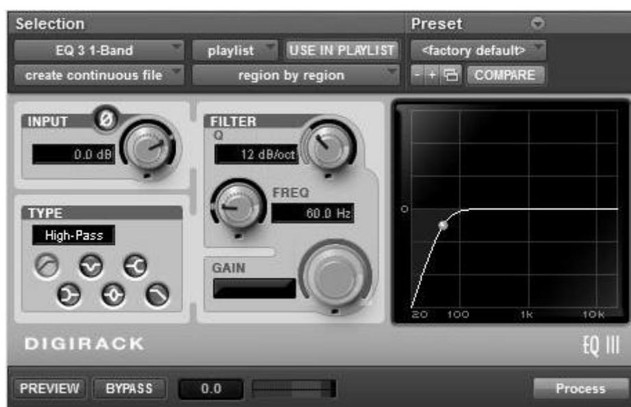
Figura 2.9.2. Ventana de configuración de filtro paso alto en *Pro Tools®*.
