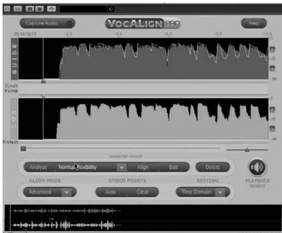
**Figura 3.1.9.** *VocAlign*® compara una guía -la toma original de producción- con la toma de sustitución –ADR-. La aplicación corta y pliega localmente para crear un nuevo archivo de sonido que generalmente hace coincidir las formas de onda. Se pueden elegir puntos de sincronización por comparación de forma de onda y seleccionar diferentes tipos de procesado según la relación calidad/ritmo que se desee.
