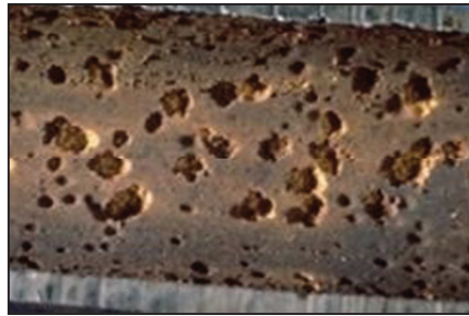
Figura 2.4. Tubería metálica dañada por MIC
