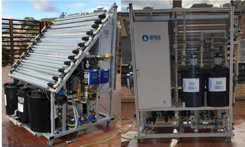
**Figura 26.** Planta piloto para el tratamiento de aguas residuales Apria Systems (vista lateral y posterior).
