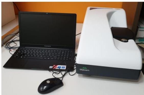
**Figura 18.** Analizador de tamaño de partícula Zetasizer Nano ZS.
