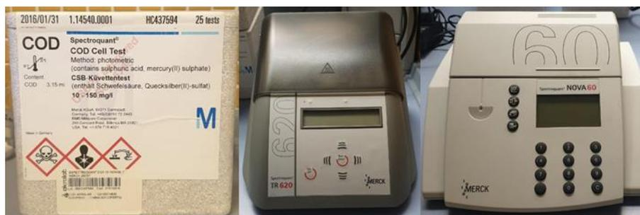
**Figura 23.** Kit para DQO, digester y espectrofotómetro para kit de determinación de DQO.
