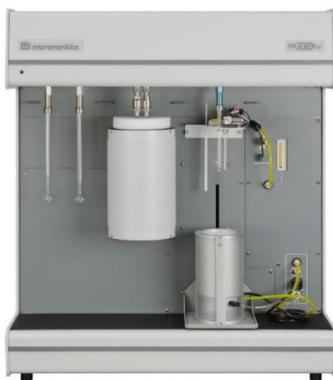
**Figura 19.** Analizador de área superficial ASAP 2020 plus.
