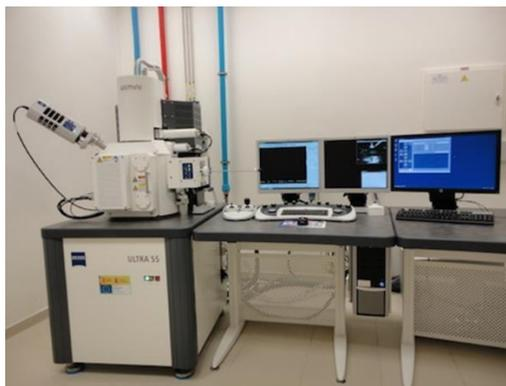
**Figura 16.** Microscopio Electrónico Barrido de Emisión de Campo.
