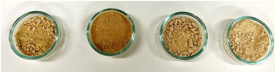
Figura 2. Apariencia de los polvos tras el secado, de izquierda a derecha: agua caliente; extrusión + agua caliente; jet cooker; jet cooker + agua caliente.
