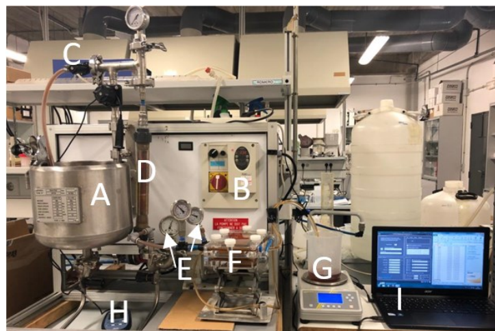
Figura 4.5. Fotografía de la planta de ultrafiltración (UPV, Valencia, España)
