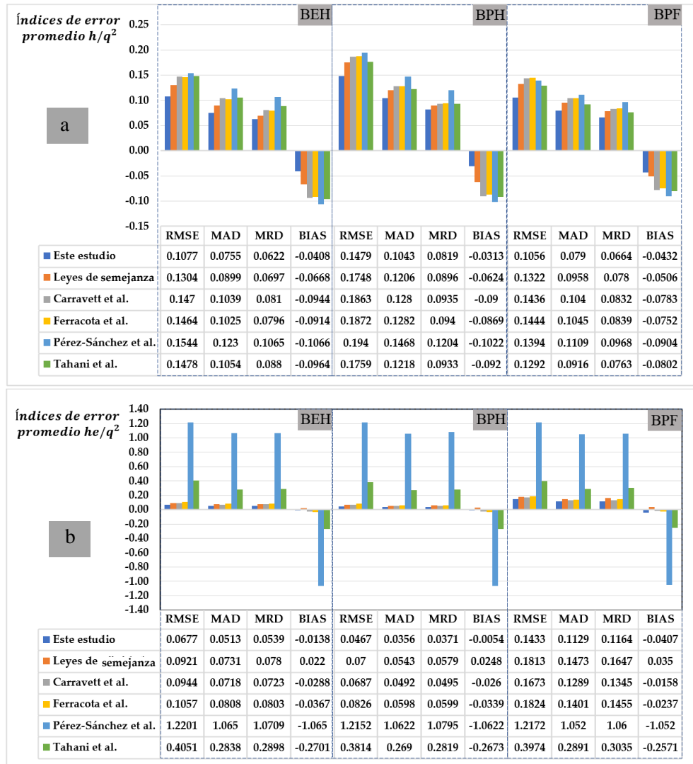
Figura 29. (a) Índices de error de los diferentes métodos aplicados a h/q^2 ; (b) Índices de error para los diferentes métodos aplicados a he/q^2
