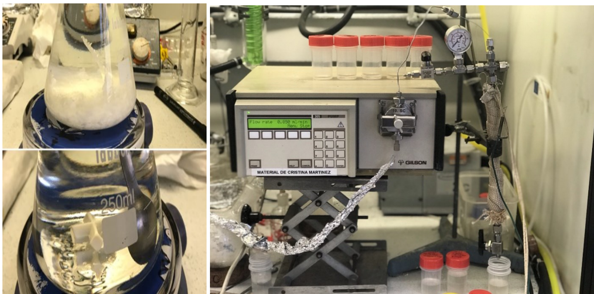
Figura 4.5. Izquierda: Mezcla de reacción antes y después de disolver los ácidos. Derecha: Reactor utilizado para la esterificación en lecho fijo, conectado a una bomba que inyecta continuamente la mezcla caliente de ácidos de aceite de coco y 2-etilhexanol.
