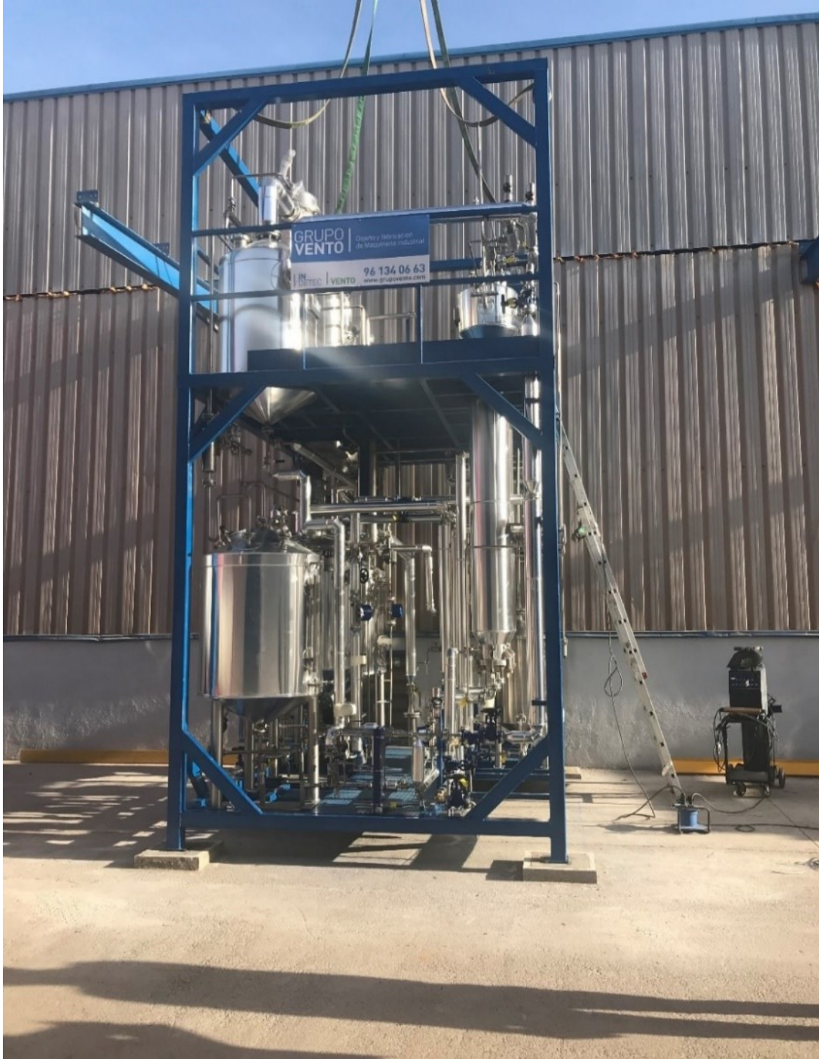
Figura 5.1. Planta piloto de reactor de lecho fijo instalada en Zschimmer & Schwarz España.
