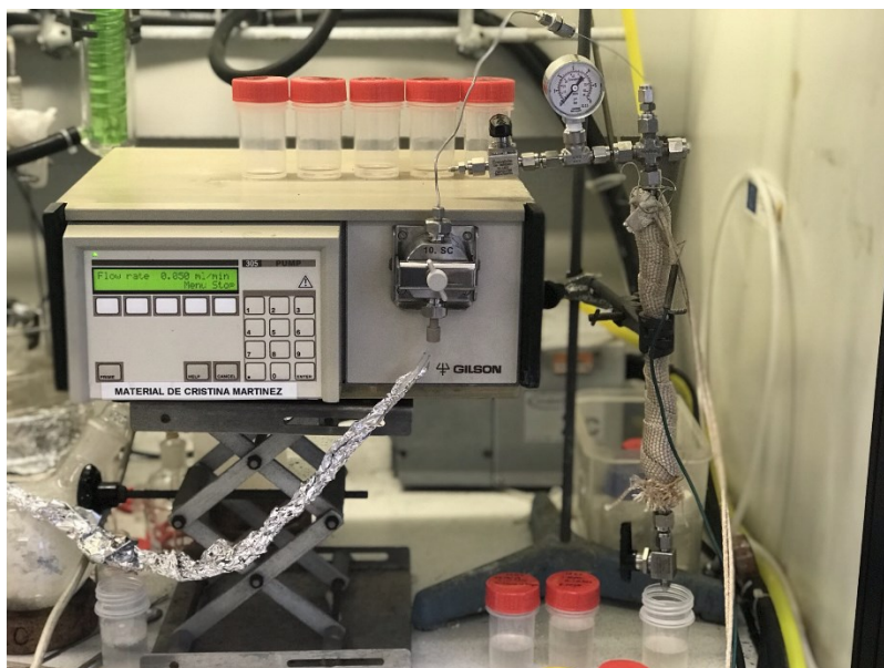
Figura 4.2. Reactor utilizado para la esterificación en lecho fijo, conectado a una bomba que inyecta continuamente la solución de ácido y alcohol en sentido anti-gravitatorio.
