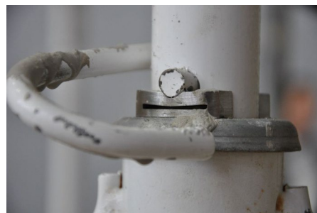
Figura 9. Registro de carga en uno de los puntales más cargados (izquierda) y estado del fusible en el momento de más carga de uno de los puntales más cargados.
