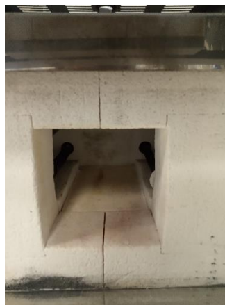
Figura 3.31. Interior de la estufa donde se calcinan los restos de los filtros a 950°C±25°C.
