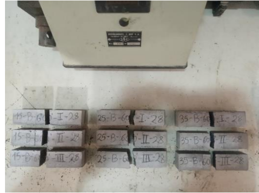
Figura 4.29. Probetas prismáticas ensayadas a flexotracción y compresión de 15%, 25% y 35% de Corazoncillo para edad de curado a 28 días.
