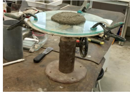
Figura 3.58. Medición de trabajabilidad de la mezcla con 25% de C. Perspectiva 2.
