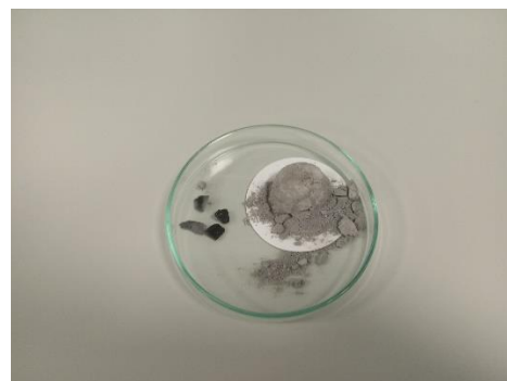
Figura 3.50. Muestra secada en estufa a 60°C.
