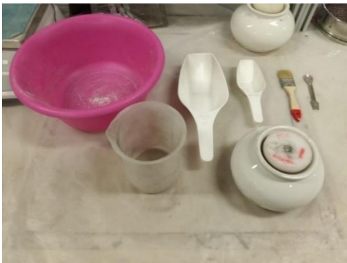
Figura 3.10. Equipos utilizados para el proceso de molienda de la ceniza volcánica.
