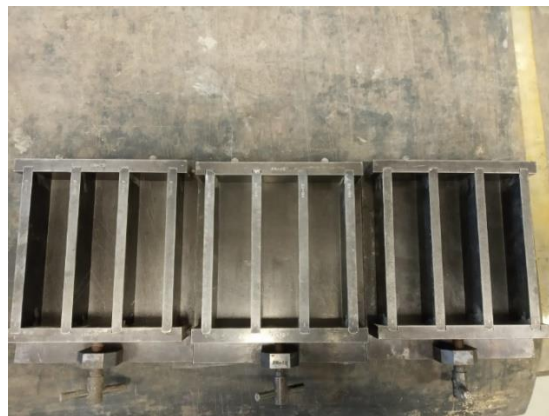
Figura 3.42. Moldes de acero para fabricar probetas prismáticas de 40x40x160 mm.
