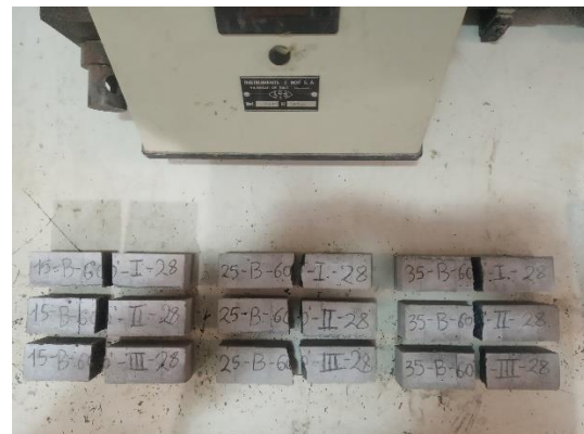
Figura 4.31. Probetas prismáticas ensayadas a flexotracción de 15%, 25% y 35% de Bombilla para edad de curado a 28 días.
