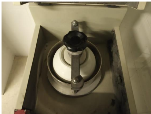
Figura 3.12. Tarro fijado dentro del molino con el brazo mecánico.
