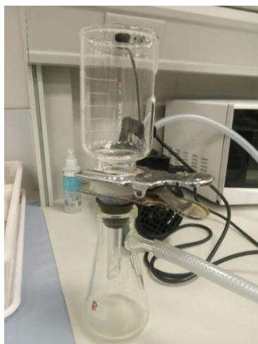
Figura 3.49. Equipo de succión para filtrado de la muestra (matraz kitasato y filtro de vidrio poroso).
