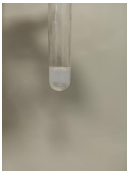
Figura 3.22. Comprobación de la presencia de iones cloruro dentro del líquido filtrado con el nitrato de plata.
