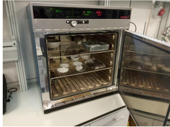
Figura 3.28. Estufa donde se introducen los filtros de papel para someterlos al proceso de secado a 60°C.
