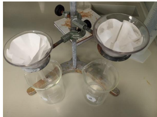
Figura 3.26. Proceso de filtración con agua desionizada y ácido clorhídrico de ceniza de San-Nicolás (N) y Corazoncillo (C).
