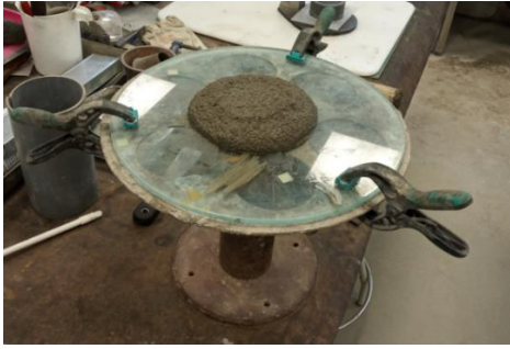
Figura 3.57. Medición de trabajabilidad de la mezcla con 25% de C. Perspectiva 1.
