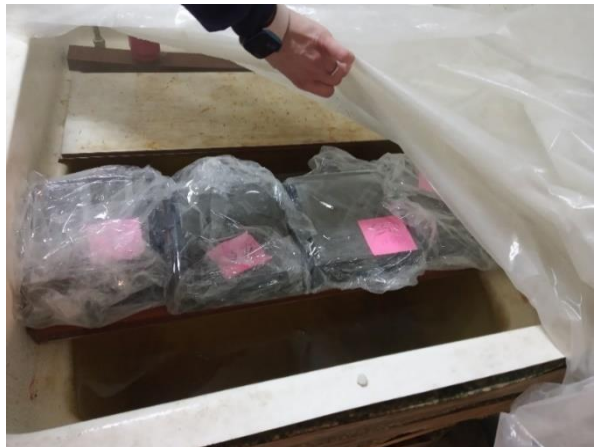
Figura 3.55. Moldes envueltos en film plástico con las probetas prismáticas con cal dentro del baño de vapor a 54°C.
