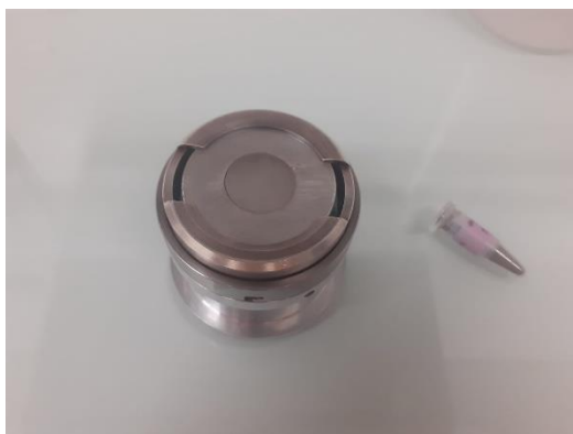
Figura 3.19. Recipiente que contiene tubos de microcentrífuga con los 4 tipos de la ceniza volcánica de la isla de La Palma y la microcentrífuga con el material a ensayar.
