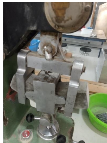
Figura 3.67. Probeta prismática ensayada a flexotracción.
