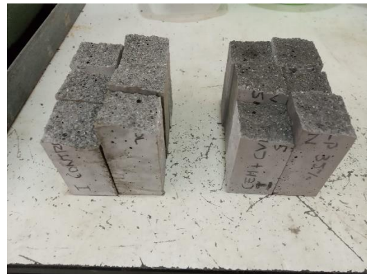
Figura 4.25. Probetas prismáticas ensayadas a flexotracción de Control y de sustitución de 35% de cemento por ceniza San-Nicolás para edad de curado a 7 días.
