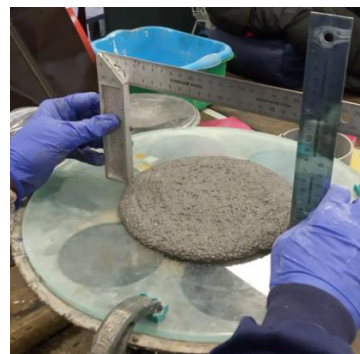
Figura 3.63. Medición de trabajabilidad del mortero de cal con a/c = 0.6 con ceniza de tipo N. Perspectiva 2.
