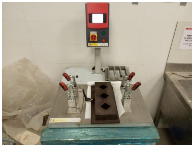
Figura 3.52. Mesa vibrante ToniVIB Modelo 5533.
