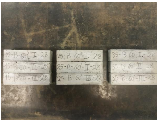
Figura 4.30. Probetas prismáticas desmoldeadas de 15%, 25% y 35% de Bombilla para edad de curado a 28 días.
