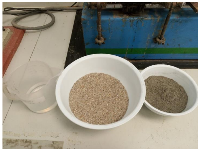
Figura 3.2. Recipientes con el agua, arenas, ceniza volcánica y cemento dosificados.
