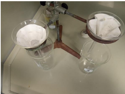
Figura 3.25. Proceso de filtración con agua desionizada y ácido clorhídrico de cenizas La Laguna (L) y Bombilla (B).
