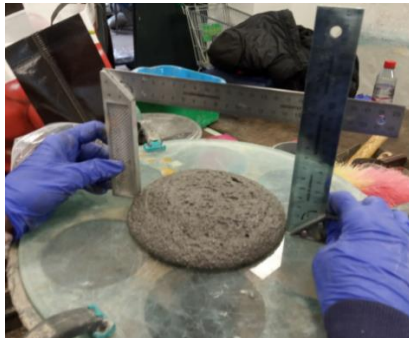
Figura 3.60. Medición de trabajabilidad del mortero de cal con a/c = 0.55 con ceniza de tipo N. Perspectiva 1.
