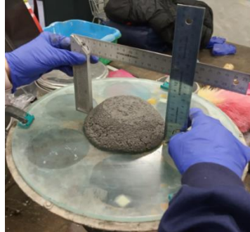
Figura 3.59. Medición de trabajabilidad del mortero de cal con a/c = 0.5 con ceniza San-Nicolás molida durante 60 minutos.
