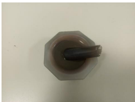
Figura 3.46. Muestra tamizada y mezclada con acetona dentro del mortero.
