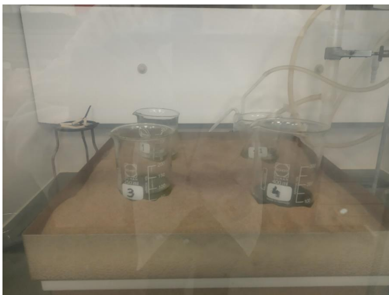
Figura 3.20. Vasos de precipitados con 4 tipos de ceniza volcánica dentro del baño de arena.
