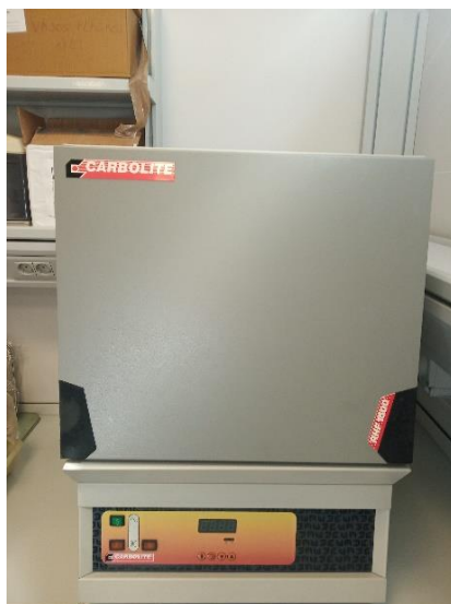
Figura 3.18. Mufla modelo Carbolite-RHF 1500.
