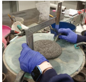
Figura 3.61. Medición de trabajabilidad del mortero de cal con a/c = 0.55 con ceniza de tipo N. Perspectiva 2.
