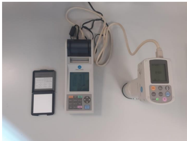
Figura 3.35. Colorímetro modelo CR-410 Chroma Meter.
