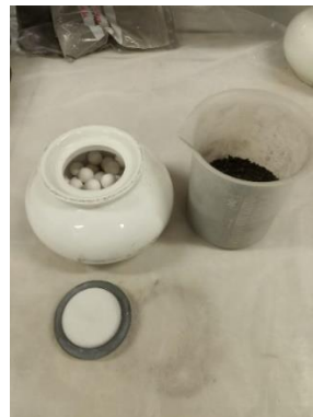
Figura 3.11. Tarro con bolas depositadas en él y vaso de precipitados con la ceniza volcánica antes de moler.
