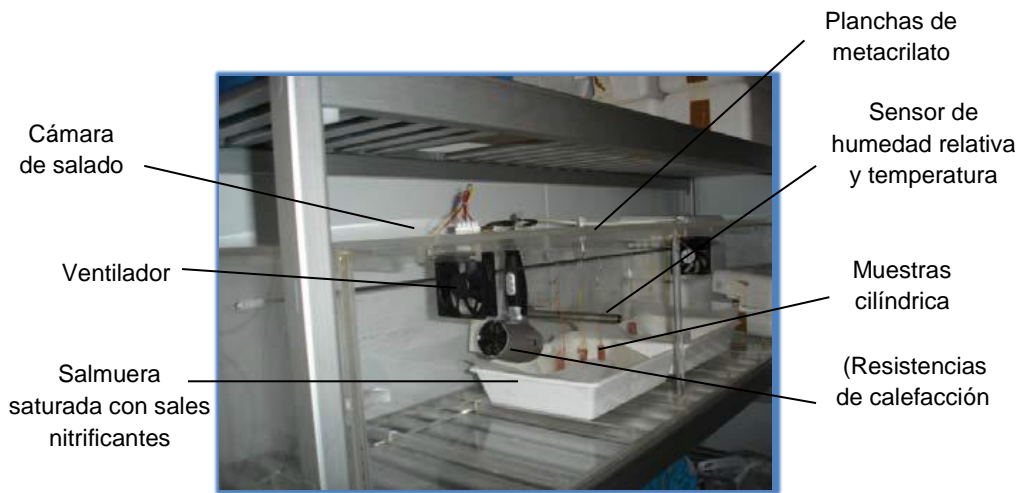
Figura 4.2.2 Detalle de una de las cámaras de salado
