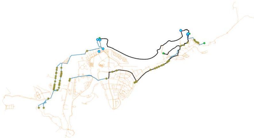
Figura 27. Nodos con demanda de caudal en la red principal y secundaria. Red Maspalomas
