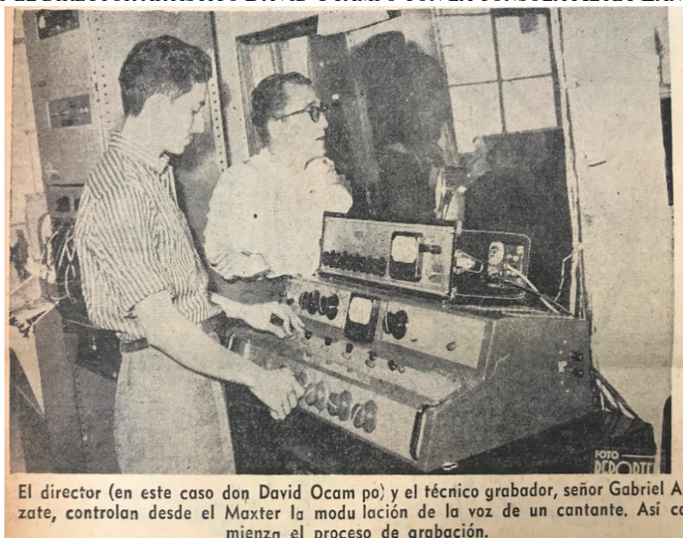
FIGURA 3.17. ESTUDIO DE CODISCOS EN EL EDIFICIO ROCA, CENTRO DE MEDELLÍN. EL INGENIERO GABRIEL ALZATE Y EL DIRECTOR ARTÍSTICO DAVID OCAMPO CON LA CONSOLA ALTEC LANSING 230B
