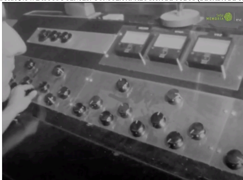
FIGURA 3.14. DISCOS FUENTES. CONSOLA ANALÓGICA DE TUBOS (DÉCADA DE 1960)
