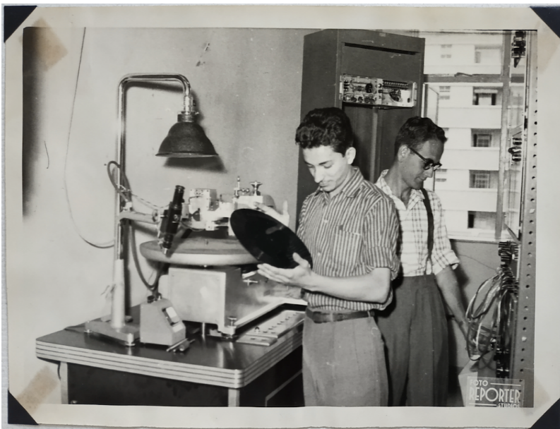
FIGURA 3.18. ESTUDIO DE CODISCOS EN EL EDIFICIO ROCA, CENTRO DE MEDELLÍN. PROCESO DE CORTE CON EL TORNO SCULLY
