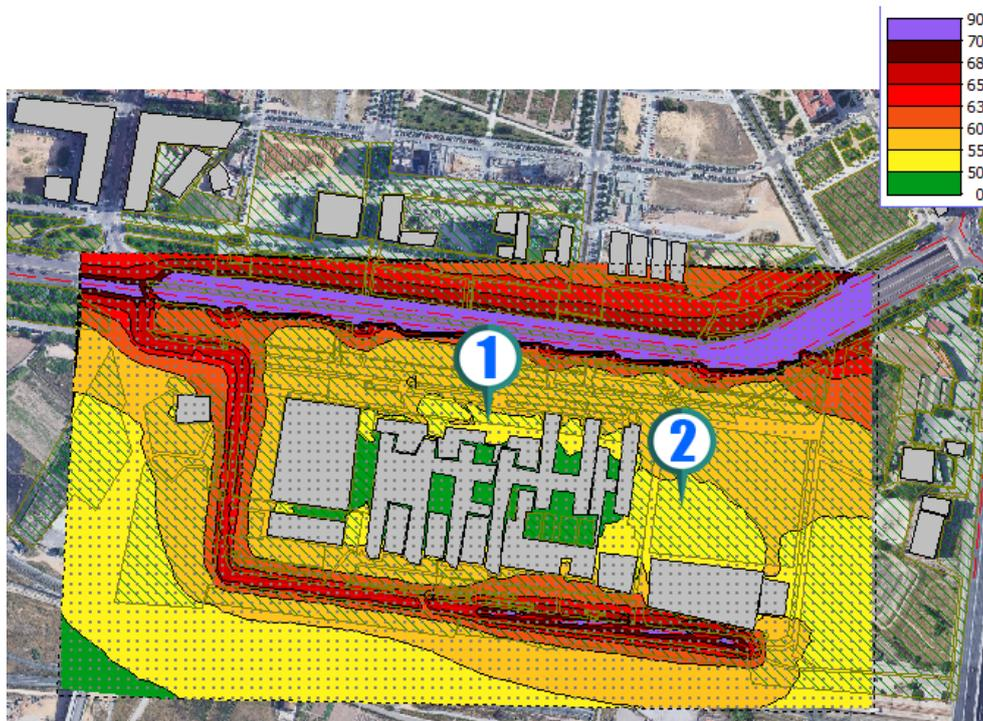
Ilustración 28: Resultados de la simulación del software Predictor con barreras acústicas
