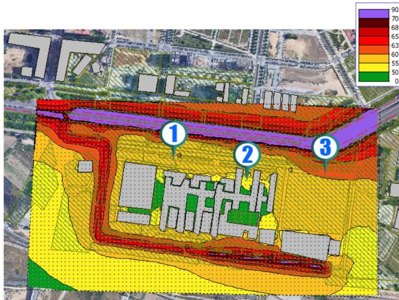
Ilustración 27: Resultados de la simulación del software Predictor con barreras acústicas
