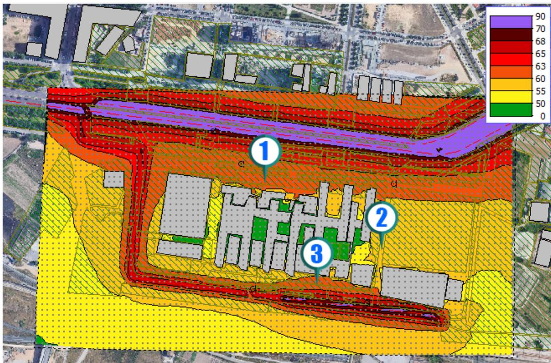
Ilustración 24: Resultados de la simulación del software Predictor con eliminación de la vía
