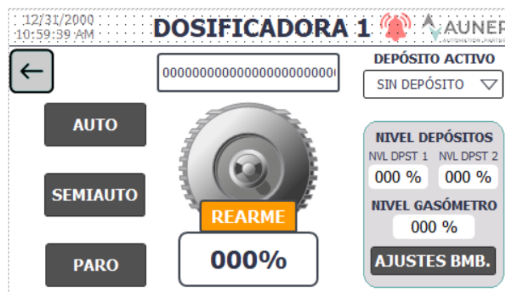
Ilustración 38 Pantalla HMI - Bomba dosificadora
