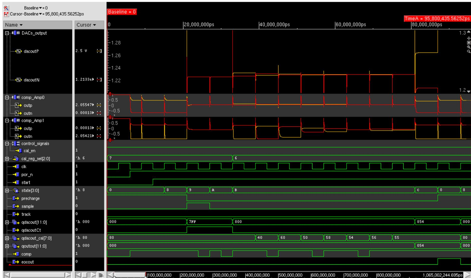
Figura 11.1: Funcionamiento del ADC en la fase de calibración
