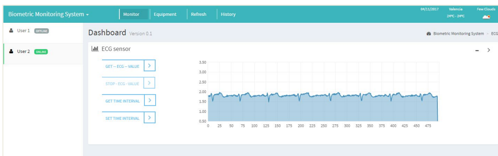
Figura 33: Pantalla de gestión y captura del sensor de ECG
