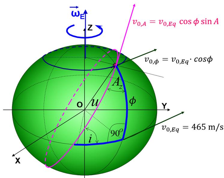
**Figura 3:** La rotación terrestre aporta una velocidad inicial al lanzamiento,  $v_{0,A}$ .
