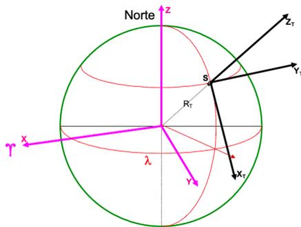
**Figura 1:** En el sistema topocéntrico-horizontal (TH), las coordenadas  $(x_T, y_T, z_T)$  tienen como origen un punto en la superficie terrestre, como plano principal el tangente en ese punto (Horizonte) y como dirección principal la del meridiano local (dirección Sur). Estos ejes NO se consideran fijos respecto a las estrellas (giran con el giro de la Tierra) y por tanto este sistema no es inercial.
