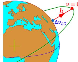
**Figura 4:** Pérdidas gravitatorias. Velocidad necesaria para elevar una altura  $h$  llegando con velocidad nula.
