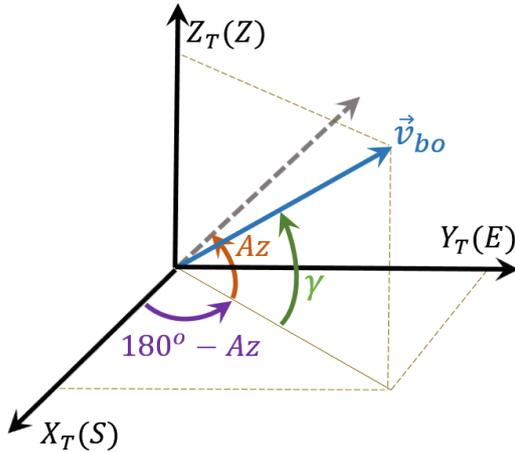
**Figura 5:** Geometría de la inserción en órbita en un sistema topocéntrico-horizontal (SEZ) mostrando el vector velocidad de inserción  $\vec{v}_{bo}$ , el ángulo de vuelo  $\gamma$  y el azimut  $Az$ .
