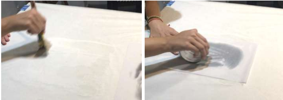
Fig. 90. Pintamos el látex sobre la manta térmica.
