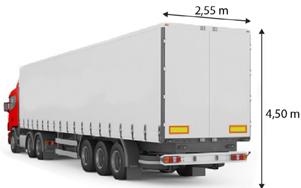
Figura 51. Dimensiones máximas del camión, ancho y alto.
