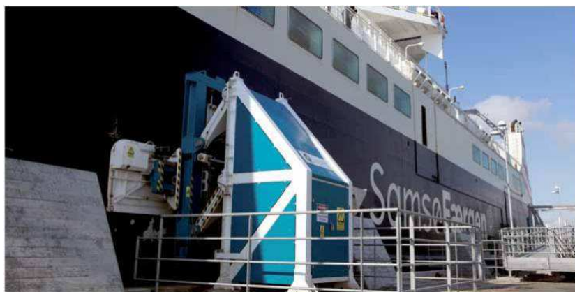
Ilustración 45. Amarre automático mediante succión en terminales. (Fuente: Exponav.org)
