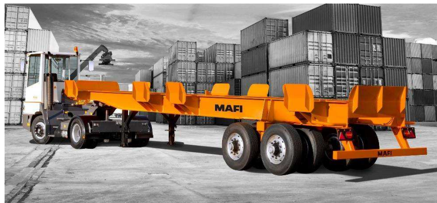
Ilustración 37. Cabeza tractora y plataforma para contenedor. (Fuente: Mafi)
