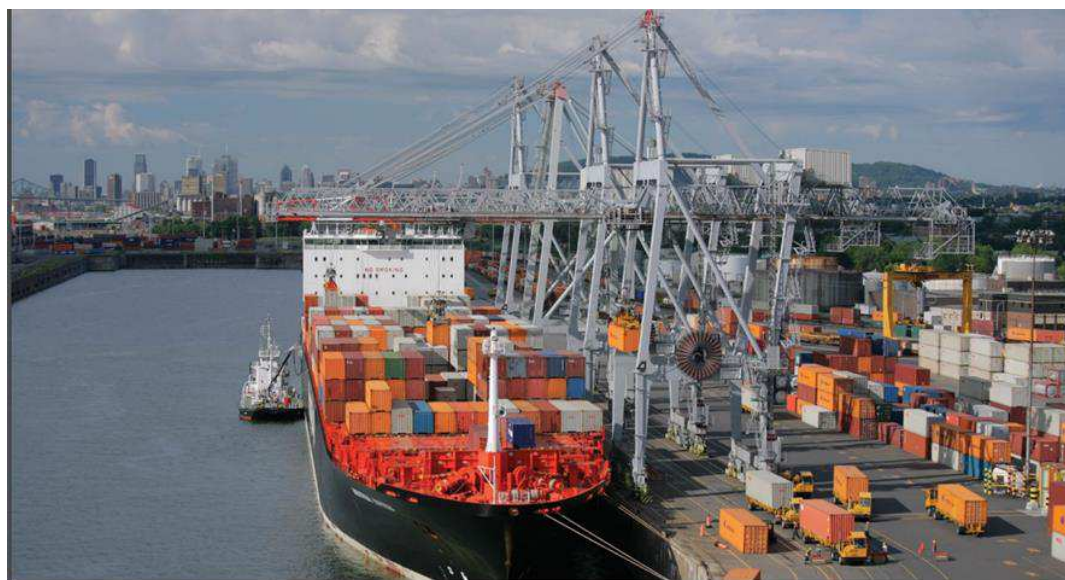
Ilustración 64. Grúas STS Feeder/Panamax de Liebherr en operativa de carga/descarga. (Fuente: Liebherr)
