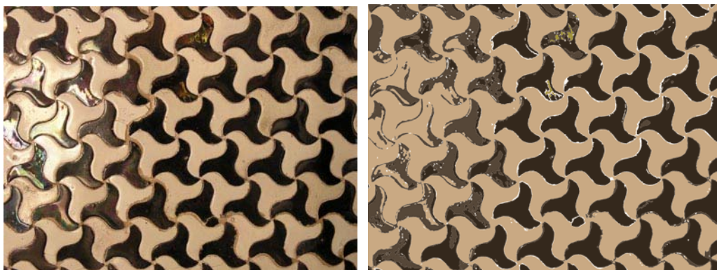
Figura 13.4: Imagen (izquierda) con un brillo intenso en la parte izquierda que causa errores en la segmentación de los objetos al confundir las partes más brillantes con el fondo y crear un color intermedio para las partes de brillo menos intenso (derecha)
