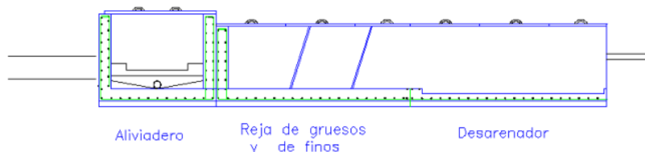
Figura 2. Línea de pretratamiento estándar para depuradoras de pequeñas poblaciones
