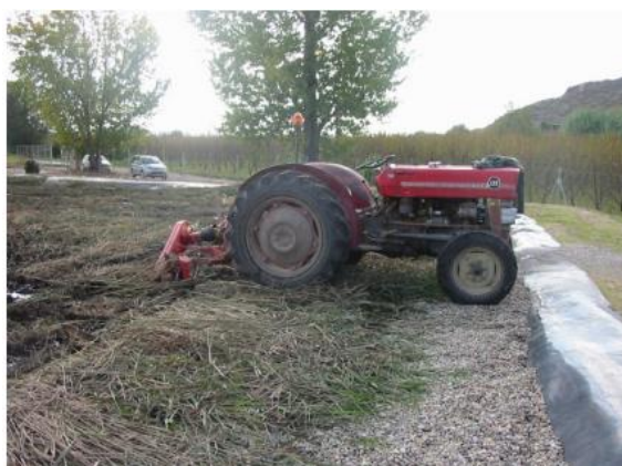
Figura 23. Maquinaria ligera usada para la siega de los vegetales en el interior de un humedal de flujo subsuperficial
