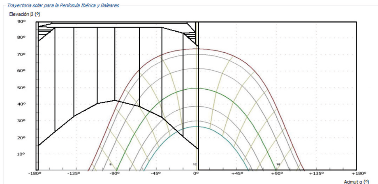
Fig.117. Patrón de sombras de panorámica orientación SUR. Ventana Este torre planta 5. SIN protección solar.
