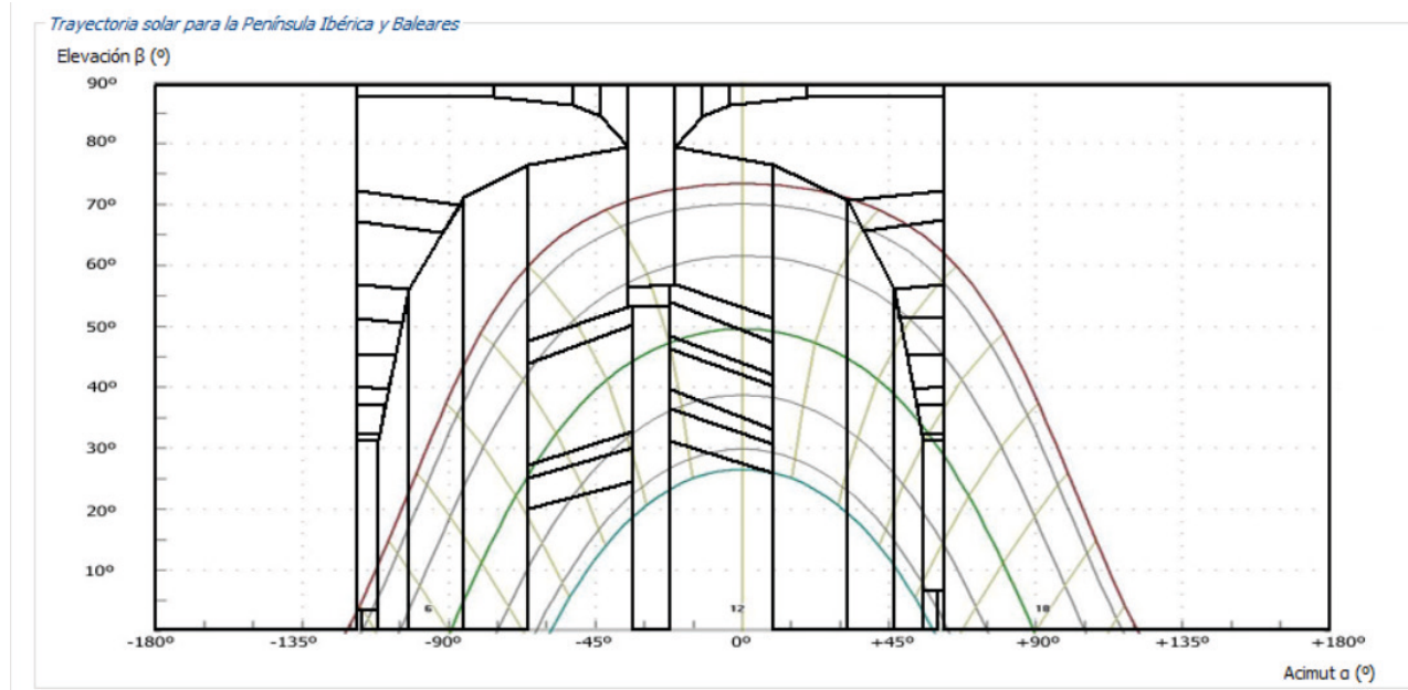
Fig.110. Patrón de sombras de panorámica orientación SUR. Ventana bloque Sur inferior. CON protección solar.
