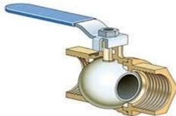
Figura 29. Válvula de esfera, fuente "Válvula de esfera". Online <https://riegoyaccesorios.es>
