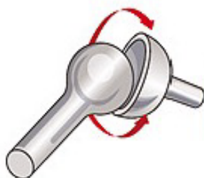
Figura 4. Esquema simplificado de una articulación de tipo esférico (grupo colaborativo ui1, 2014).
