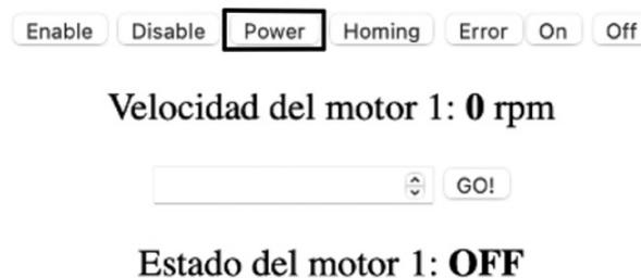
Figura 8. Interfaz de usuario. Ventana de estado del servomotor 1. Encendido del servomotor mediante el botón *Power*.
