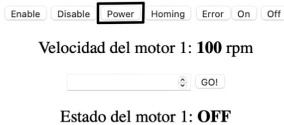
Figura 14. Interfaz de usuario. Ventana de estado del servomotor 1. Apagado del servomotor mediante el botón Power.
