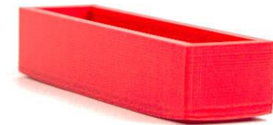
Figura 26. Warping , producido por un contraste de temperaturas. (Cahoon S, 2016)
