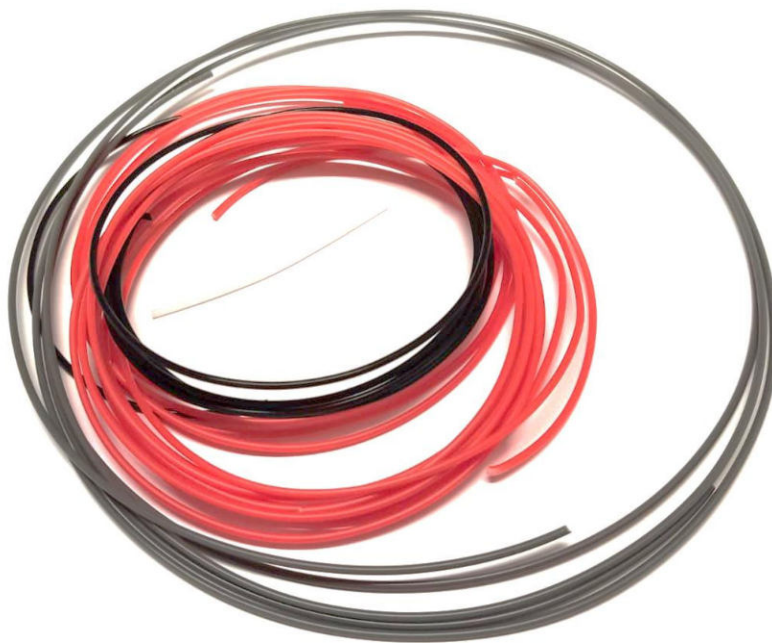
Figura 53. Roturas de filamento debido a la humedad o estrés mecánico.
