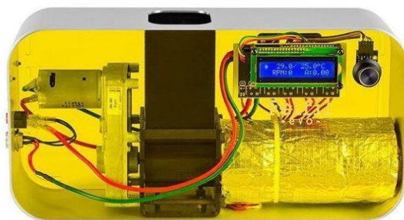
Figura 45. Felfil EVO ensamblada sin carcasa, apreciándose el interior del producto. (Felfil, s.f.)
