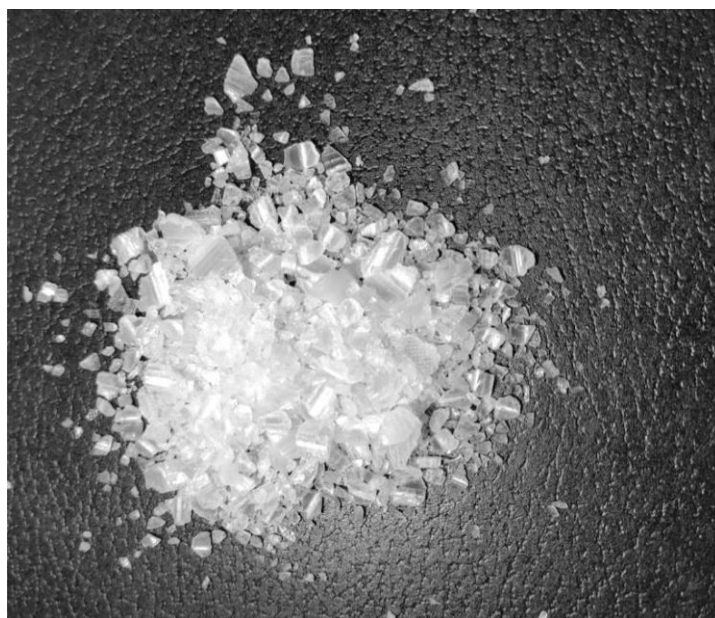
Figura 62. Distintos tamaños triturados de los cilindros de PLA.
