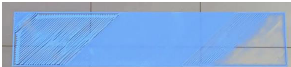
Figura 27. Modelo que no se ha impreso bien por falta de adherencia. (Jellimann, B, 2018)
