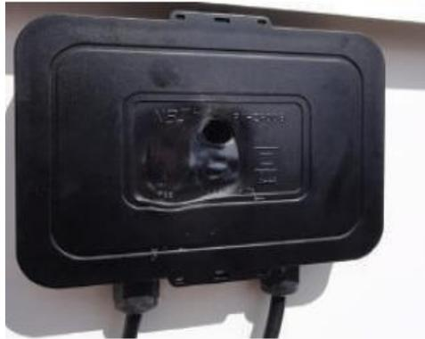
*Figura 49: Caja de conexiones quemada por conexión defectuosa. Fuente: [8]*
