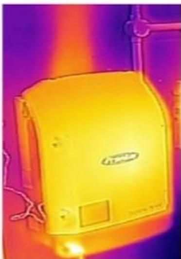
En caso de que alguna conexión eléctrica supere los 60 °C, se deberá medir la tensión e intensidad de está comprobando que está dentro de valores normales, en caso contrario se deberá sustituir la conexión y analizar las posibles causas raíz de dicho incremento de temperatura, se seguirá la misma operativa en caso de otros puntos anormalmente calientes en el inversor.
