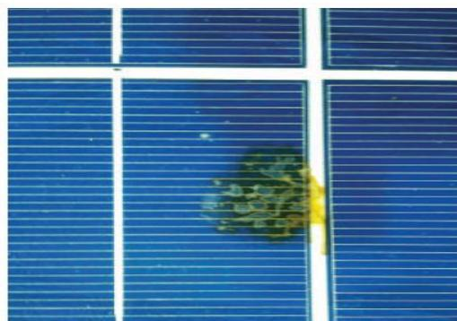
**Figura 33:** Ejemplo de delaminación. **Fuente:**[8]
