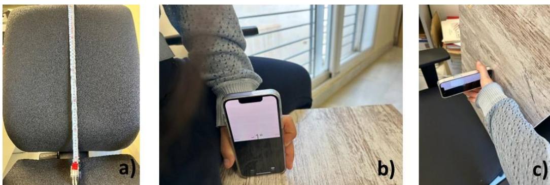
Figura 24. medida de dimensión de la longitud del respaldo de la silla; b) medida del ángulo del asiento; c) ejemplo medida ángulo del respaldo
