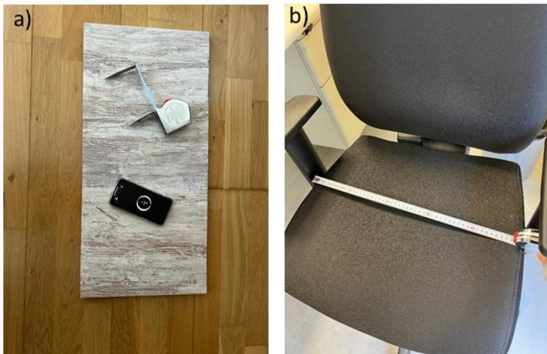
Figura 22. Sistema de medición de dimensiones. a) elementos del equipo (tabla, cinta métrica con extensiones e inclinómetro); b) Ejemplo de la anchura del asiento
