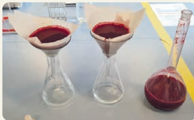
Figura 1. Disolución de colorante con arcilla filtrando.
