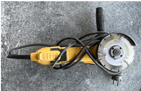
Figura 1: Radial provista de disco diamantado
